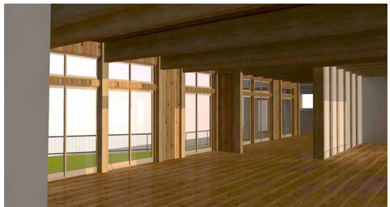
内観パース 内壁 (耐力壁)・天井は CLT パネルあらわし、木軸は燃えしる設計
