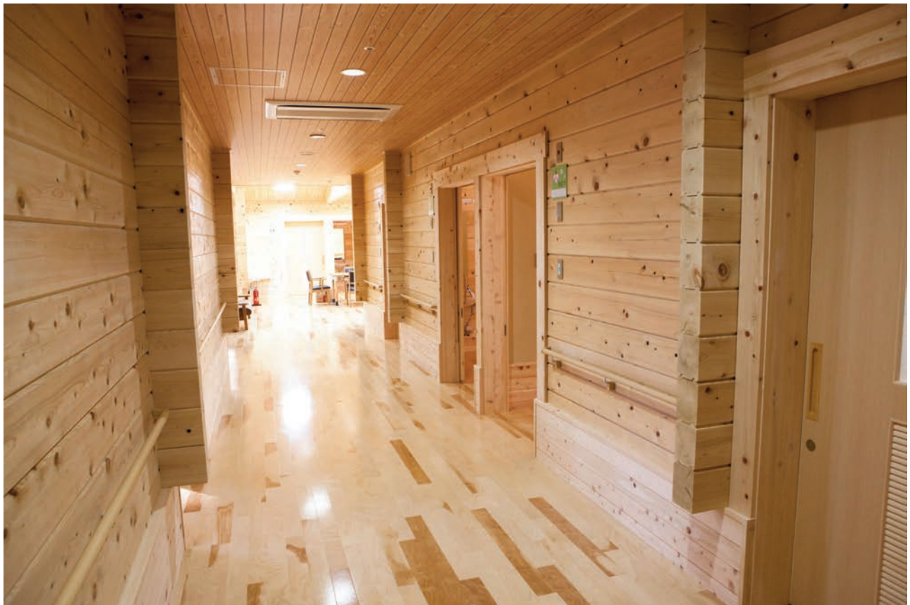
居住棟は丸太組構法でつくり、内部は重厚な木に包まれている
